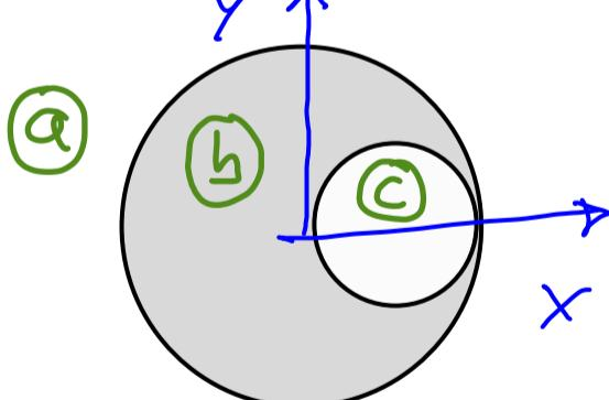
$$\vec{B}_a = \vec{B}_{1e} + \vec{B}_{2e} \rightarrow \text{fuera del cilindro}$$
