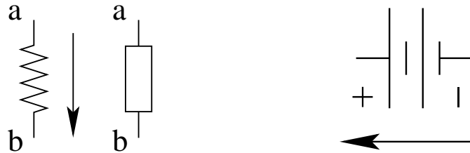
Figura 8.1: a) Distintos esquemas para representar resistencias eléctricas. La flecha indica el sentido de la corriente según la ecuación V_a - V_b = RI . b) Esquema eléctrico de una pila o acumulador. La flecha indica la dirección de la corriente eléctrica en el interior de la pila (en ausencia de fuerzas electromotrices adicionales).
