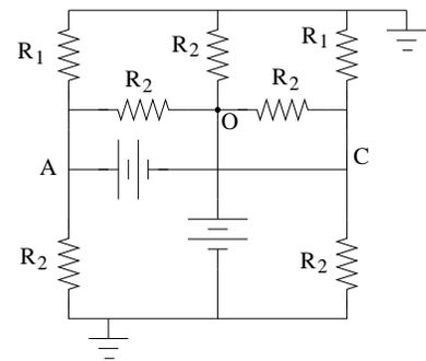
16. El circuito de la figura está formado por resistencias del mismo valor  $R$ , pilas de fuerza electromotriz  $\epsilon$  y resistencia interna  $R$ , y un potenciómetro cuya resistencia  $R'$  puede variarse a voluntad. Se pide:
