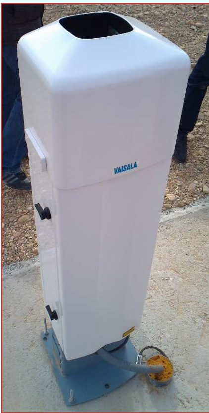
Ceilómetro CL31 para detectar altura de nubes
