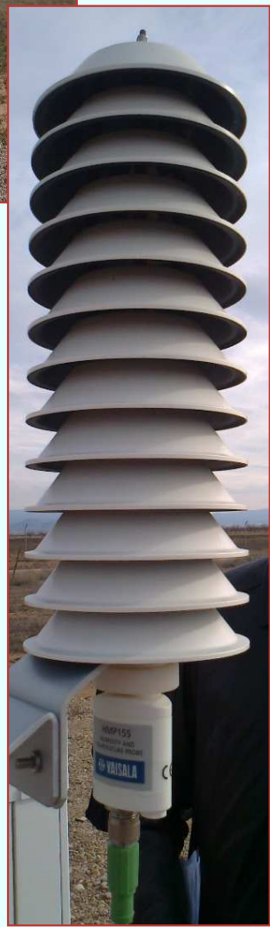
Sonda de humedad y temperatura HMP155
