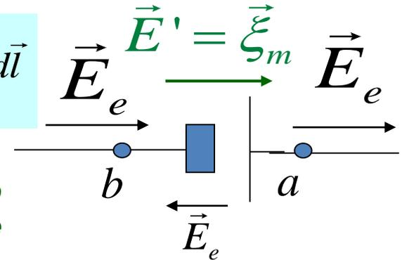
**Campo electromotor** (definición formal) no es un campo electrostático (sí lo es  $E_e$ ) que produce separación de carga libre en generador para mantener corriente .
