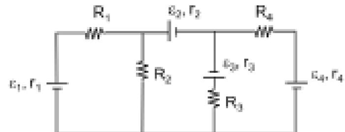
Datos:  $\varepsilon_i = 10\text{ V}$ , resistencias internas  $r_i = 1\ \Omega$  y las resistencias  $R_i = 1\ \Omega$ , para  $i = 1, 2, 3, 4$ .
