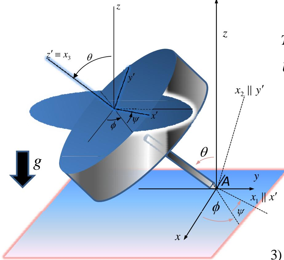
$$T = \frac{1}{2} \vec{\omega} \cdot \bar{\bar{I}}_A \cdot \vec{\omega}, \quad \bar{\bar{I}}_A = \begin{bmatrix} I_1 & 0 & 0 \\ 0 & I_1 & 0 \\ 0 & 0 & I_3 \end{bmatrix};$$
