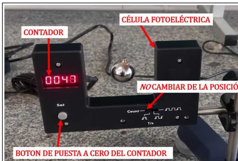
Fig. 1: El contador de oscilaciones instalado en las prácticas.
